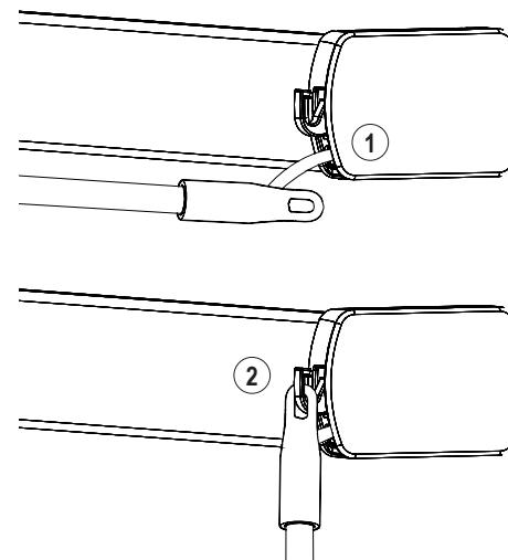
Sur les stores alvéolés, la baguette sera déjà connectée au store (1). Avec les boutons de commande de la baguette étant tournés vers vous, fixez le haut de la baguette dans le support de crochet en plastique du côté de la commande du moteur (2).
