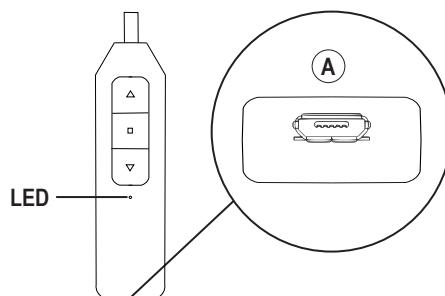
Pour recharger, connectez un câble micro USB standard au bas de la baguette (A) et à une alimentation USB 5V/2A (max). Une LED rouge sur la baguette indique que la batterie est en cours de chargement. Pour charger complètement les batteries, laissez-les se charger pendant au moins une heure après que la LED sur la baguette soit devenue verte.
