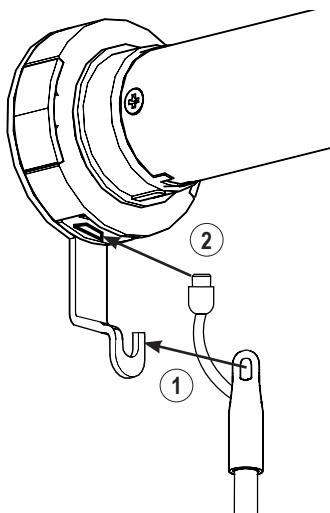
Sur les stores à bandes, les stores à enrouleur et les stores translucides, les boutons de commande de la baguette étant tournés vers vous, fixez le haut de la baguette sur le support de crochet en métal (1) du côté de la commande du moteur, puis connectez le câble dans la tête du moteur (2).
