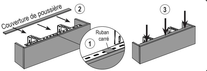
Retirez la protection de l'adhésif des rubans carrés et placez les rubans carrés sur le coin en fentes. Ensuite, placez la couverture de poussière par-dessus le coin en fentes et appuyez dessus pour fixer l'adhésif.
