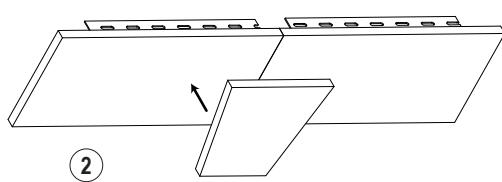
Premièrement, placez les deux ou trois sections de la corniche en tissu sur une surface droite face vers le bas et alignez-les bord à bord. Installez les supports à épissure avec les vis fournies et passez à l'étape **1. Installez les Supports**. Une fois la corniche installée, attachez la clé de voûte avec les bandes velcro fournies au centre pour recouvrir l'épissure.
