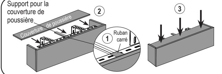
Retirez la protection de l'adhésif des rubans carrés et placez les rubans carrés sur le coin en fentes. Ensuite, placez la couverture de poussière par-dessus le coin en fentes et appuyez dessus pour fixer l'adhésif.
